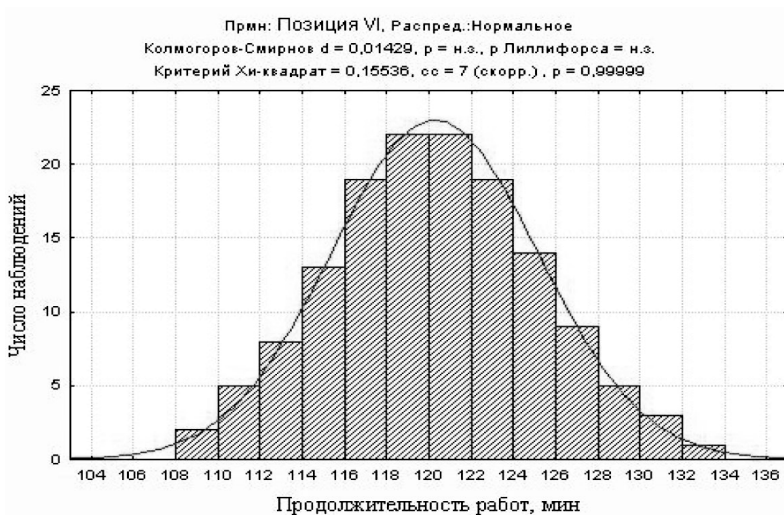
Рис. 5.6. Гистограмма и кривая плотности распределения случайной величины времени выполнения ремонтных работ на VI позиции потока
